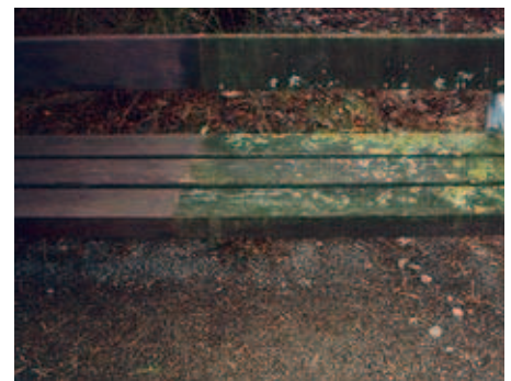
Legno esotico dopo 20 anni senza manutenzione, e il risultato dopo l'avvenuto ritrattamento.
